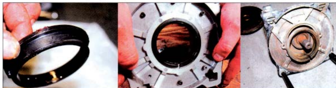
Obr. 2 Kluzná ložiska bubnů: 1 - Xwinč, 2 - „čína“, 3 - Warn
