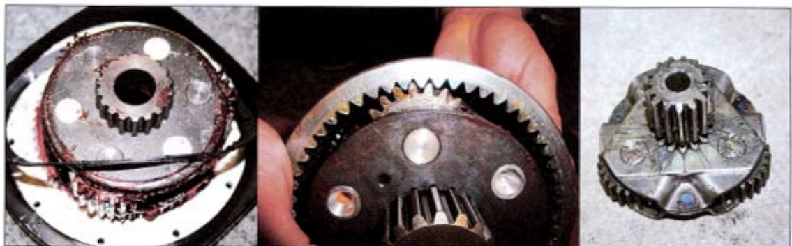
Obr. 3 Převodovky: 1 - Xwinch, 2 - „čína“, 3 - Warn
